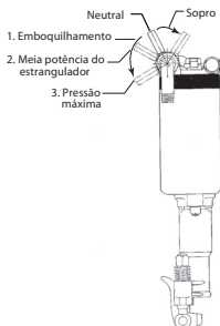
Figura 1. (Des. 16578304) Operando as Posições da Alavanca
